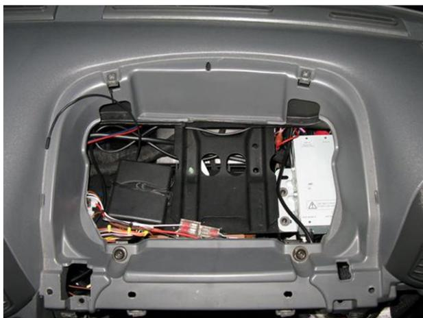
Abb. 6: VT-500TW unter der Ablage
