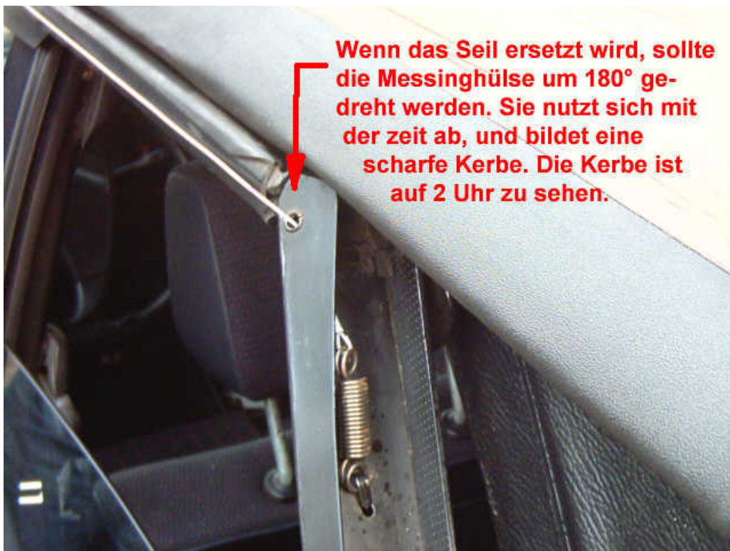
Abbildung 4: Messinghülse in der "C-Säule"
